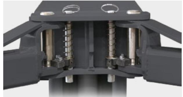
Dispositif de sécurité du bras avec verrouillage automatique et déverrouillage automatique lorsque le bras atteint le sol.
