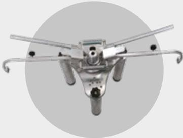
Les griffes à 3 points STDA92, idéales pour toutes les roues de camion, permettent d'éliminer la procédure de dévoilage des roues.
