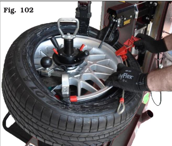
8. En utilisant la bonne taille selon le type de jante (EH, EH2), insérez la première cale, et en appuyant lentement sur la pédale de rotation, insérez toutes les autres en séquence. Continuez lentement la rotation jusqu'à ce que le pneu soit complètement assemblé (**Fig. 103**)
