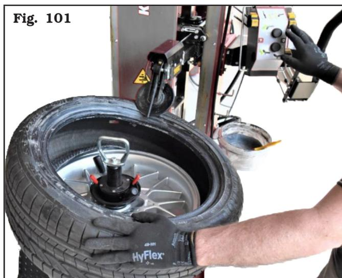
4. En appuyant sur la pédale de rotation, positionner la soupape vers 3 heures, à l'aide du poussoir approprié (Fig. 59 réf. C), positionner la tête outil sur le bord de la jante.
