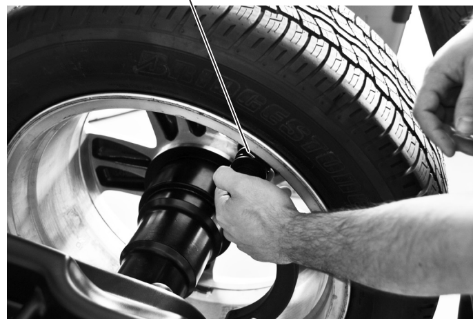
Applicare il peso nella posizione in cui la pinza tocca la ruota
