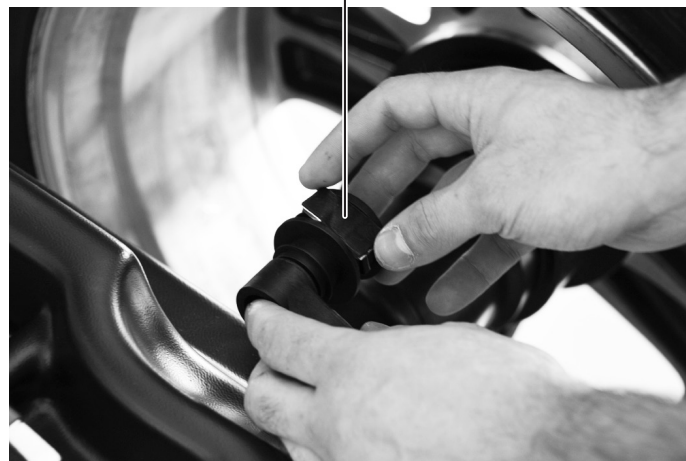
Inserire nella pinza dell'asta del calibro il peso adesivo
