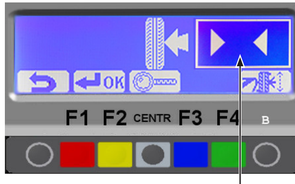
Genauere Radstellung zum Anbringen des Gewichtes
