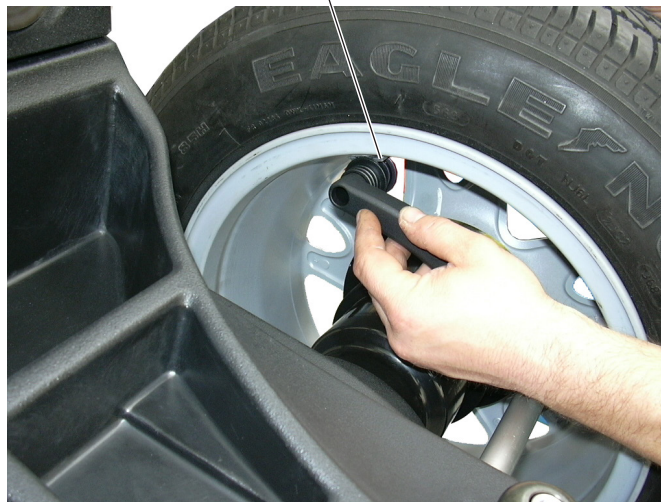
Aplicar el peso en la posición en la cual la pinza toca la rueda
