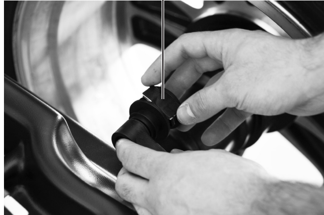
Introducir en la pinza de la varilla automática el peso adhesivo
