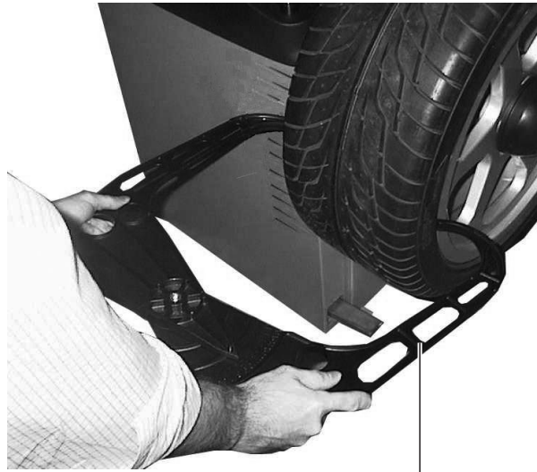
MANUELLER BREITENTASTER Manuelle Breitemessung
