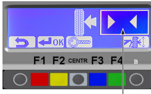
Genaue Radstellung zum Anbringen des Gewichtes
