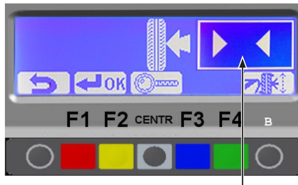
Position exacte de la roue pour appliquer le poids
