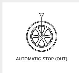
La máquina se detiene automáticamente en la posición de desequilibrio exterior.
