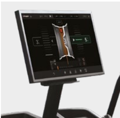
Auswuchtprogramme: Dynamisch, Statisch, ALU und ALU-S, Trennung der Gewichte, Gewichte hinter den Speichen und Optimierungsprogramm.
