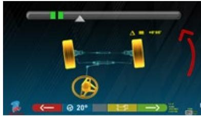
Procédure de braquage effectuée électroniquement via les capteurs CCD, ce qui permet d'obtenir la valeur d'incidence et d'inclinaison du montant avec une grande précision.
