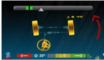
Das Einschlagen erfolgt elektronisch mit Hilfe von CCD-Sensoren, um den Inzidenz- und Neigungswert des Ständers mit einer hohen Genauigkeit zu erhalten.
