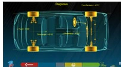
Die schnelle Diagnose von Fahrwerksfehlern ermöglicht die Erkennung möglicher Probleme mit der Karosserie oder der Hinterachsverschiebung (nur bei Modellen mit 8 Sensoren).
