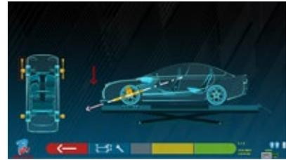
Durch das Spoiler-Programm, für Sportwagen mit einem niedrigen Profil, erfolgt die Messung automatisch und ohne den Einsatz von Zubehör.
