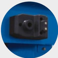
Transmission à rayons infrarouges entre les détecteurs ; efficace même dans des conditions d'éclairage critiques.
