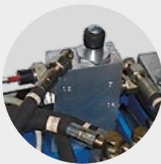
La sincronizzazione idraulica dei movimenti delle pedane è indipendente dalla ripartizione del carico; ed è garantita da un **dispositivo di sincronizzazione idraulica brevettato**.
