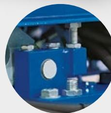
Basi dotati di **registri di regolazione** che facilitano le operazioni di installazione.
