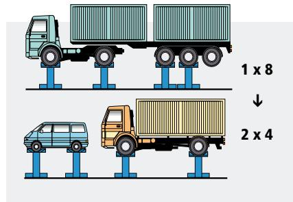
Impianti elettrici modulari per consentire successive variazioni sulla configurazione (es. passaggio da 4 a 6 o 8 colonne. Utilizzo di due set da 4 colonne ottenuti separando un set da 8 colonne...).
