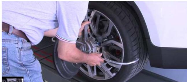
(\*) È conveniente montare le graffe coi target ed accendere le 2 teste di misura già in questa fase preliminare, per consentire al sistema di riconoscere ed “agganciare” i 4 target posizionati sulle ruote.
