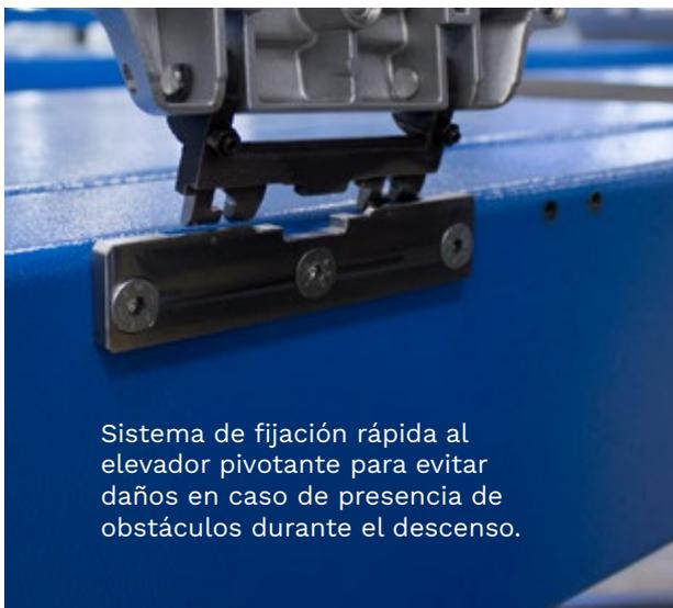
Sistema de fijación rápida al elevador pivotante para evitar daños en caso de presencia de obstáculos durante el descenso.
