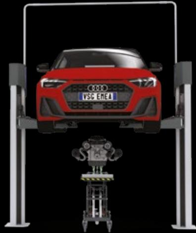
Las mesas elevadoras de la **serie KT**, en combinación con los accesorios que se adquieren por separado, permiten alojar motores, transmisiones, baterías de alta tensión e incluso unidades de accionamiento completas.
