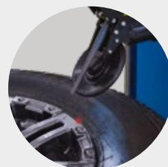
Puntatore laser che indica il corretto posizionamento degli utensili.
