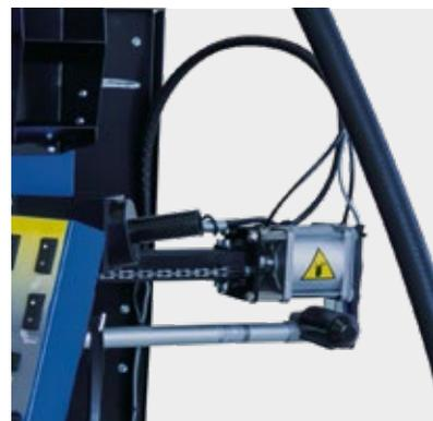
Attuatore elettromeccanico che controlla, tramite un sistema di sincronizzazione a catena, il movimento contemporaneo di tutti e tre i bracci operanti.
