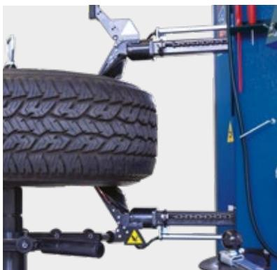
Sistema di stallonatura a doppio disco. Lo pneumatico viene stallonato in modo rapido e sicuro da due dischi opposti sincronizzati.
