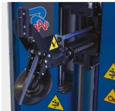
Capteur avec activation automatique de la fonction d'avance des disques pour un détalonnage précis et sans risques pour les pneus.
