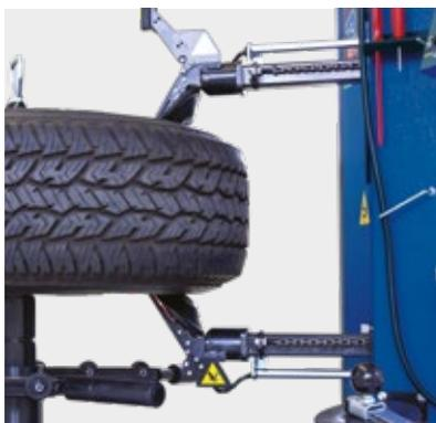
Système de détalonneur à double rouleau. Le pneu est détalonné rapidement et en toute sécurité par deux disques opposés et synchronisés.
