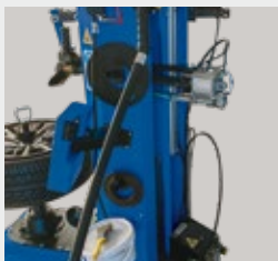
Funzione di avanzamento dei dischi per una stallonatura corretta e sicura.
