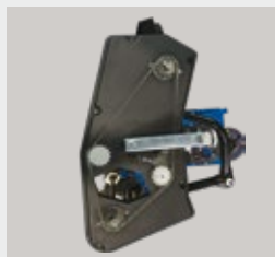
Posizionamento sincronizzato dei tre bracci tramite un sistema a catena.
