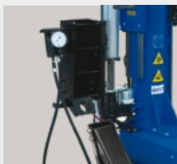
Gonfiaggio a pedale con manometro e valvola bilanciatrice.
